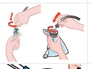
3. Raccorder les différentes parties entre elles. Le bleu va avec le bleu et le gris avec le gris. Pousser et tourner jusqu'au blocage des connecteurs. Ne pas forcer.
