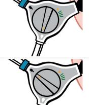
4. Tourner le curseur de l'unité de contrôle pour le positionner sur le symbole eau \( \rightarrow \) et presser la poire jusqu'à immersion de la sonde dans le sachet.
